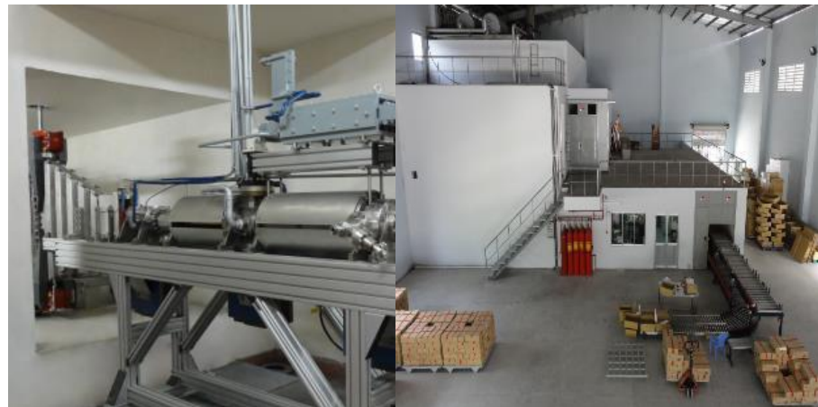
Предприятие по радиационной обработке на базе линейного ускорителя электронов высоких энергий, 10 MeV, 20 кВт
